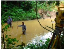
b) Levantamiento con estación total en una quebrada.
