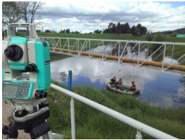
a) Levantamiento con estación total en cauce profundo.
