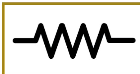
Figura 1.80 [Simbología de un resistor]
