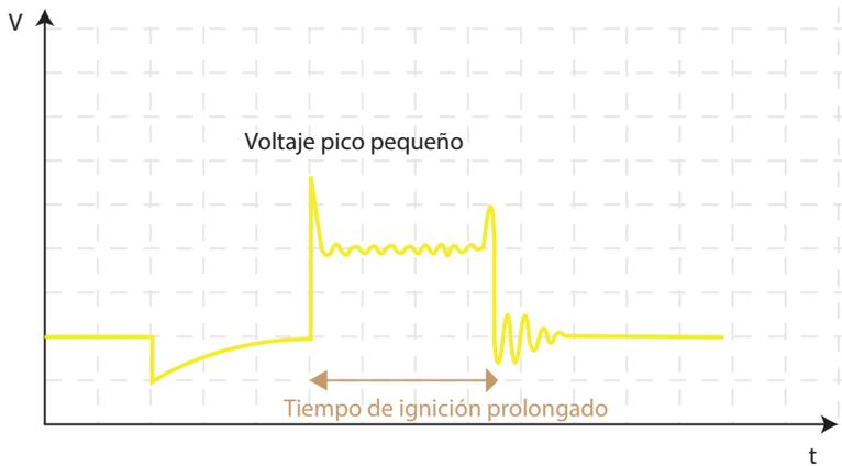
(b) Oscilograma del voltaje con una distancia menor para el salto de la chispa
